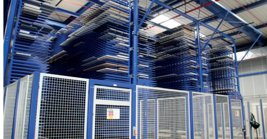
Ein großes Pufferlager nimmt die Teile der Vorfertigung auf und lagert diese bis zu zwei Tage ein, bis sie kommissionsbezogen diese Produktionshalle in Richtung Bohrautomat und Montage verlassen.
